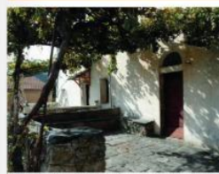
La treille filtre le soleil d'été et laisse passer les rayons bas d'hiver.
