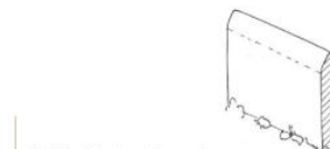
Muret de clôture terminé par un glacis
